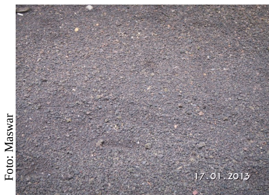
Gambar 4. Permukaan lahan gambut yang bersifat seperti pasir semu ( pseudo sand ) akibat kering tidak balik ( irreversible drying )
