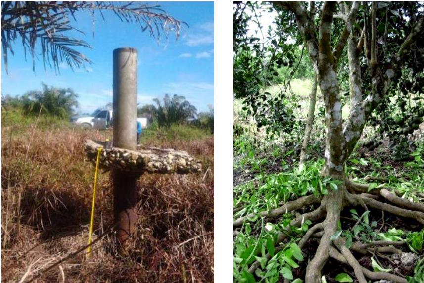
Gambar 3. Amblesan (subsiden) pada lahan usaha tani padi (kiri) dan jeruk (kanan) di tanah gambut ( tebal > 2 m)
