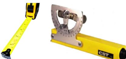
Abney level untuk mengukur kemiringan lereng
